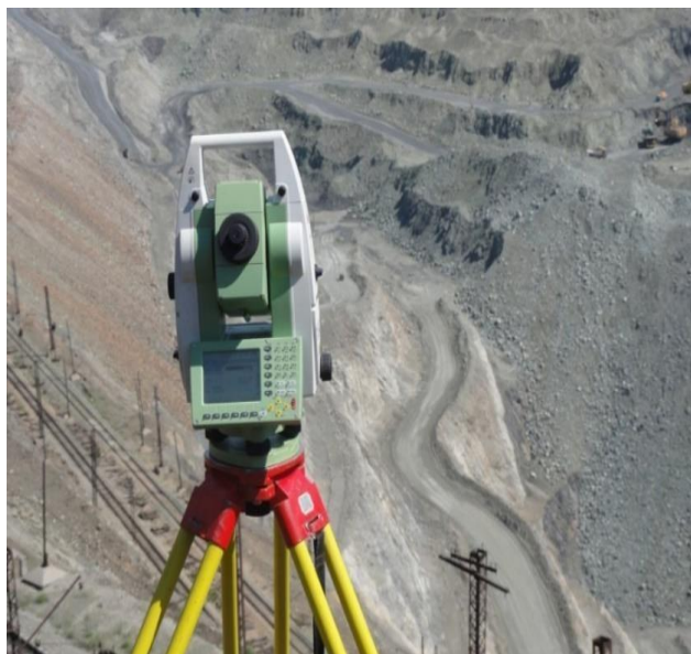
12 Сурет – TSA1202 роботталған электронды тахеометрді пайдалана отырып Қоңырат карьерінің батыс бортының жағдайын аспаптық бақылау
